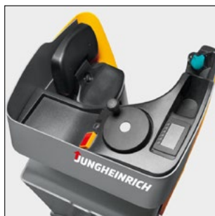
ESE 120 til stående fører med let tilgængelige betjeningslementer og opklappeligt sæde
