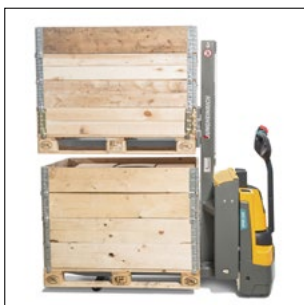
Dobbelt-dækkerfunktion: Optag af to paller over hinanden
