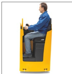
Behagelig siddestilling med gulvplade, der kan indstilles i højden i ESE 220/320
