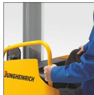
Holdebøjle giver sikker ind- og udstigning og mulighed for montering af forskelligt ekstraudstyr
