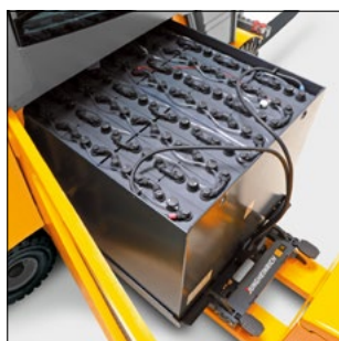
Batteriskift fra siden
