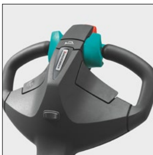
Alle køre- og løtefunktioner i ergonomisk multifunktionelt styrehåndtag.
